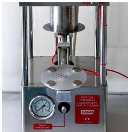
Εικόνα 2: Τμήμα του Potter Spray Tower
